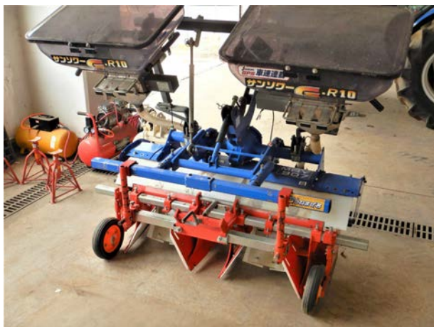
写真4 畝内部分施用機（2条用）と主要構造
