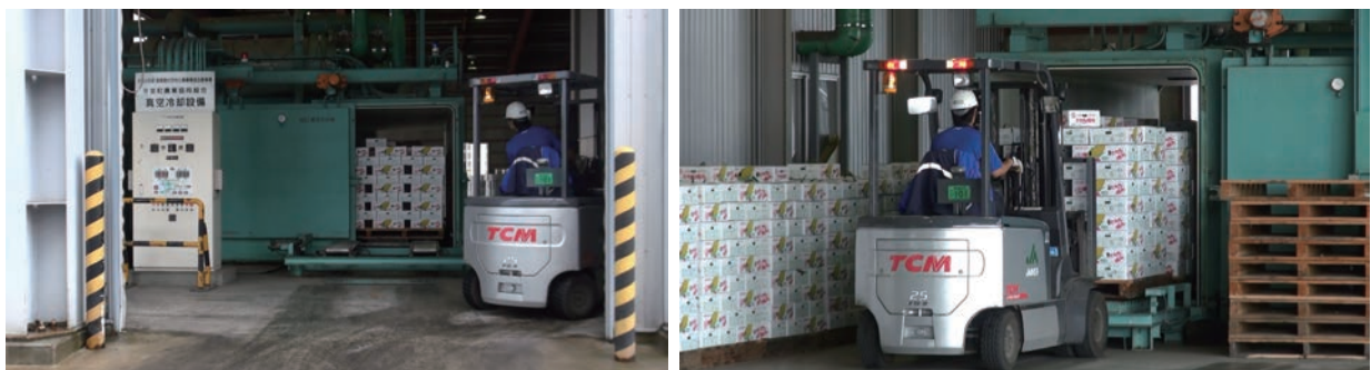
写真3 鮮度を保持するため、真空予冷機で品温を下げてから、予冷库へ搬入
