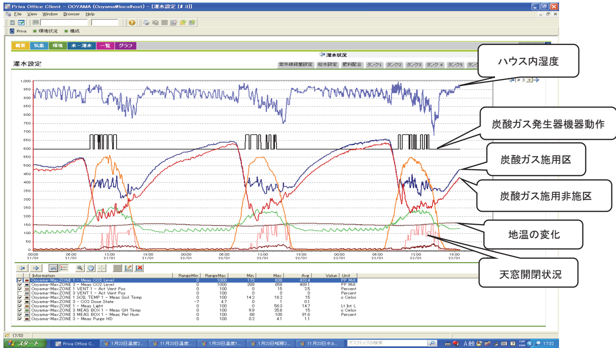
図3 統合環境制御システム「マキシマイザー」を活用した炭酸ガスの施用
