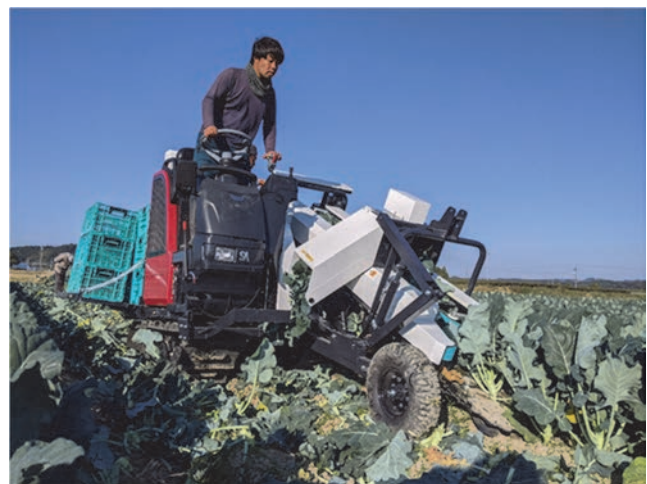
写真2 ブロッコリーのAI付き収穫機 (鈴生提供)
