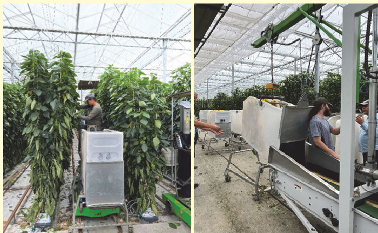
コラム写真2 FTEK社のピッキングリフト (NZ、オークランド) (左：収穫作業の様子。リフトは前後上下に移動可能。 右：収穫物はリフトから搬送コンベヤーに搬入可能。)
