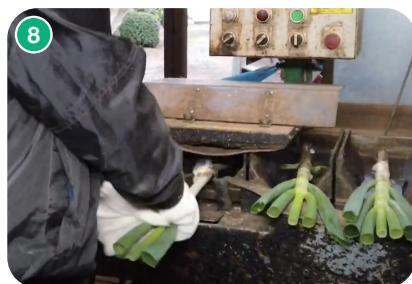
ねぎの皮むき機は、エアを放出することで皮をむき、根を切って調製します。
