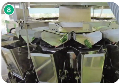
集出荷場に運ばれたピーマンを、自動選別機で等級別に仕分けし、自動組み合わせ機によって個包装します。
