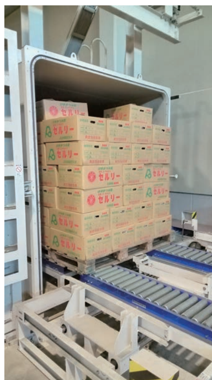
写真5 品質保持のための真空冷却処理
