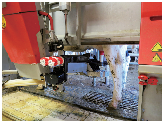
首輪のタグに記録された情報を通じて、牛 1 頭 1 頭を管理します。搾乳ロボットも、このタグの情報で自動的に牛 1 頭 1 頭の乳量をデータ化します。
