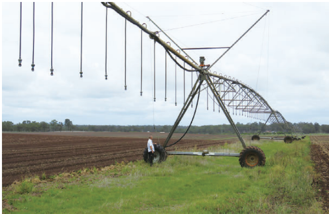
写真2 ピボット灌漑（左）とホースリール（右）（QLD州バンダバーグ市）
