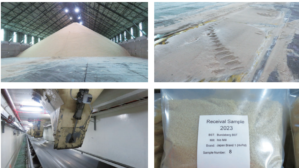
写真6 粗糖倉庫（左上）、粗糖倉庫床の切出し口（床が開いて粗糖が下へ落ちる）（右上）倉庫下ベルトコンベア（左下）、日本向けハイポールの保管サンプル（右下）
