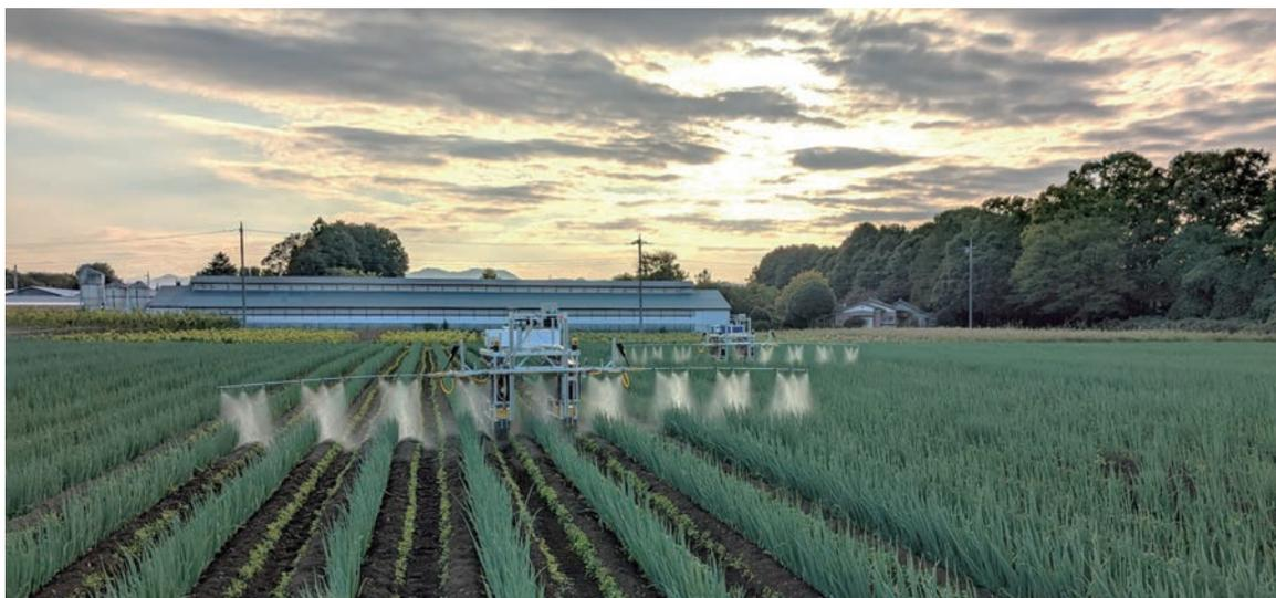
写真2 株式会社レグミンの自律走行型農薬散布ロボット
