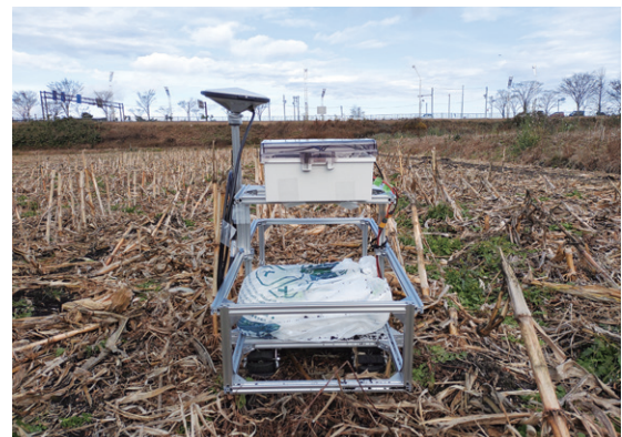
写真11 重量物積載試験の様子
