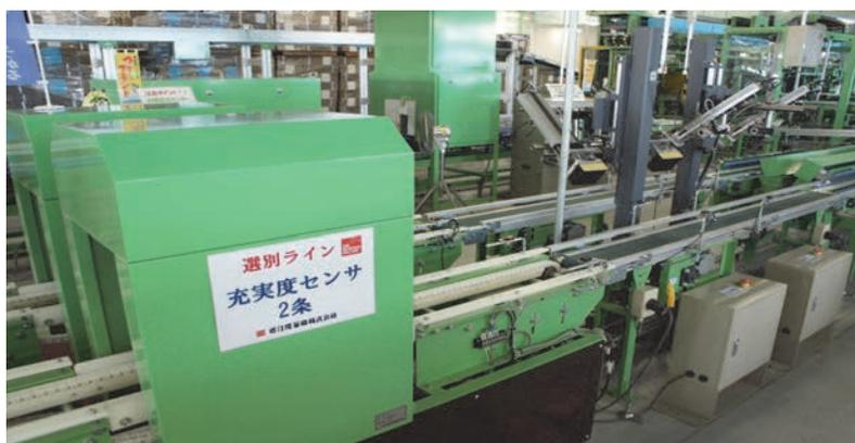
写真5 メロンの重量・体積・密度を計測する充実度センサー
