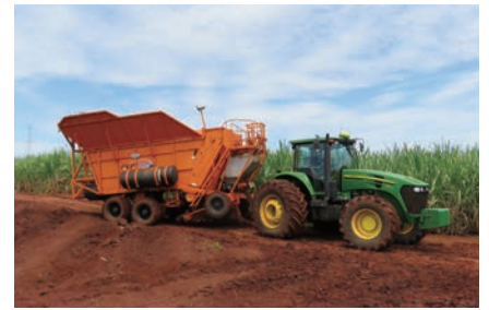
③ 植え付け機（John Deere社:7230J TRACTOR + DMB社:PCP 6000 Planter）
