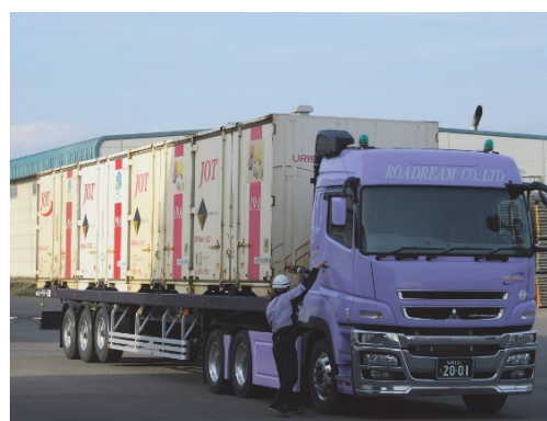
写真6 ロングトレーラーによる輸送頻度の削減
