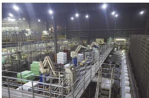
写真1 パレタイズロボット導入による段ボール積みの自動化
