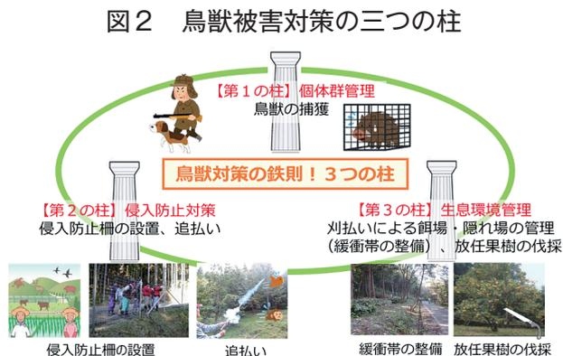
侵入防止柵を設置する場合は対象となる野生鳥獣に有効なものを選ぶ必要があります。例えば、木に登ることができるクマは金網柵では侵入を防ぐことができず、電気柵が最も効果が高いです。また、侵入防止柵は設置して終わりではなく、柵下部地面の掘削による侵入や倒木による損傷部分からの侵入が報告されていますので、定期的な補修・管理が重要です。
