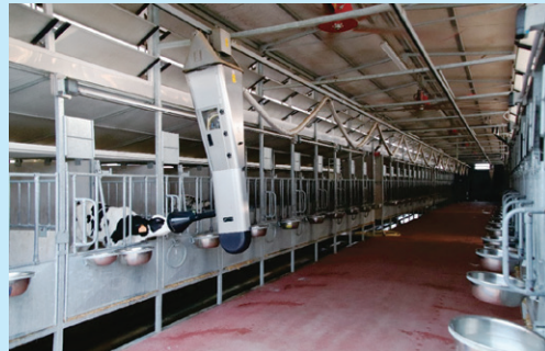
コラム1－写真2 自動給餌ロボット（左）、自動哺乳ロボット（右） （2021年に建設した牛舎内の電力やヒーターは、農場のプラントからの電気やガスで賄っている。）
