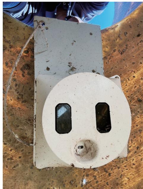
写真3 飼料残量確認システムのセンサー部分（有限会社菊永ポートリー提供）
