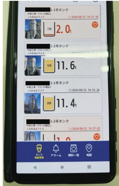
写真2 飼料残量管理システムでスマートフォンから飼料残量を確認する様子（残量があらかじめ設定した基準の割合を下回るとアラートが表示される仕組みになっている。）
