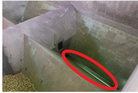
写真2 ポテトピンとばれいしょが運ばれる水路（水で押し流して次の工程へ運ばれる）
