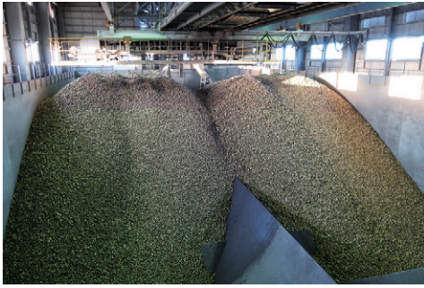
写真2 ポテトピンとばれいしょが運ばれる水路（水で押し流して次の工程へ運ばれる）
