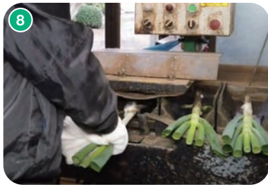
ねぎの皮むき機は、エアーを放出することで皮をむき、根を切って調製します。
