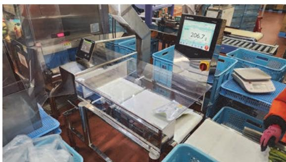
写真4 小袋へパッキングした製品の計量作業
