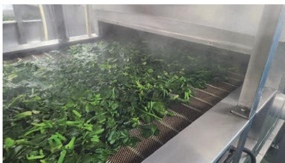
写真5 冷凍前に蒸気で行うブランチング（スチーム処理）
