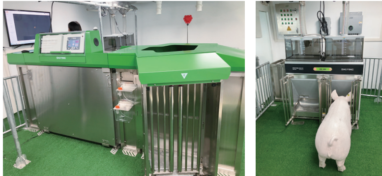
写真8 肥育豚の体重測定機（左）と補助飼料の自動給餌機（右）
