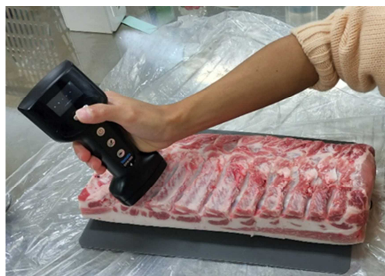
写真 Fish Analyzer での豚ロース部分肉のインピーダンス測定
