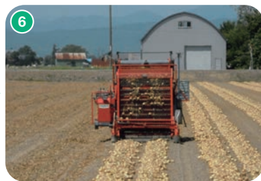
6 機械で掘り起こしながら、余分な葉や根を落としながら収穫します。
