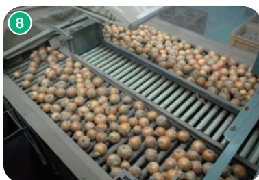
8 乾燥したたまねぎを、自動選別機で選別します。
