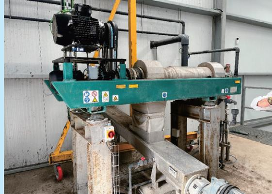
コラム写真3 排せつ物貯留施設（左）、固液分離機（右）
