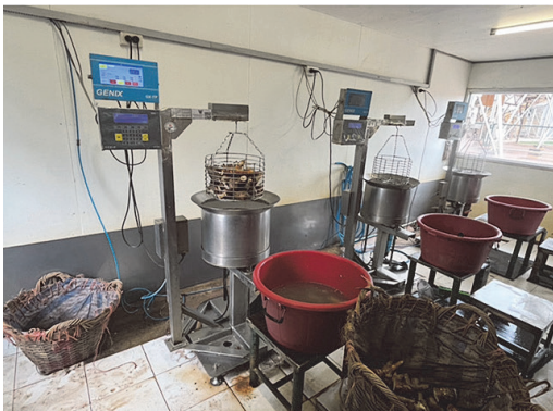
写真1 でん粉含有率の検査機器と検査用にカットされたキャッサバ
