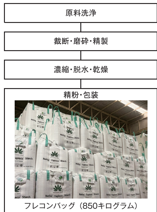
図6 RGS社のタピオカでん粉製造工程
