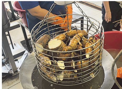
写真1 でん粉含有率の検査機器と検査用にカットされたキャッサバ
