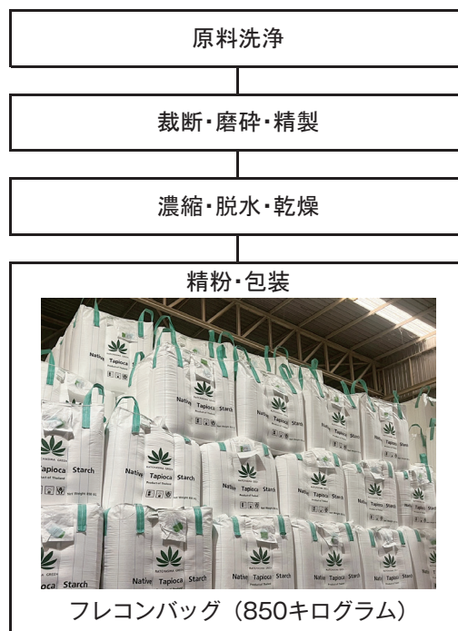
図6 RGS社のタピオカでん粉製造工程
