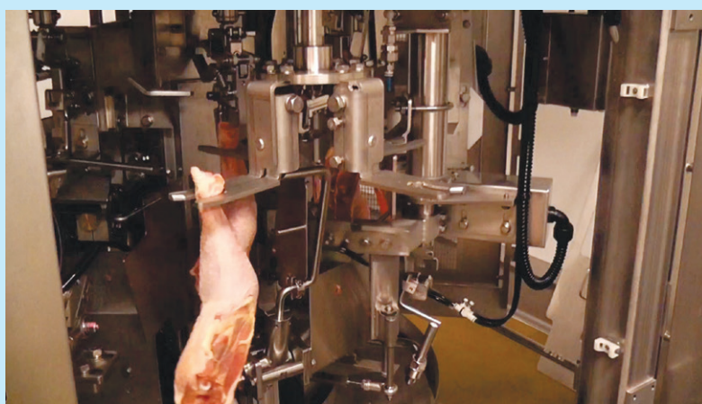
コラム一写真1 鶏モモ肉全自動脱骨ロボット「トリダス（TORIDAS）」
