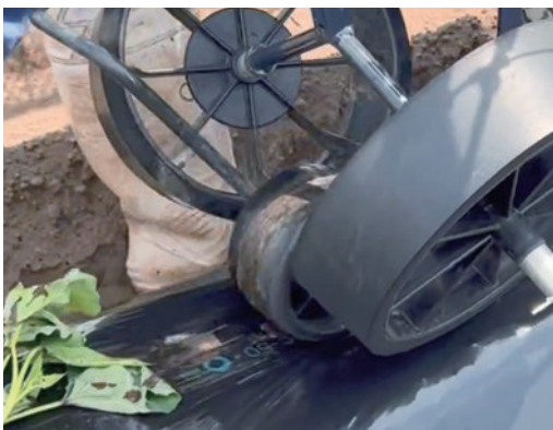
写真4 鎮圧ローラによる植穴の鎮圧
