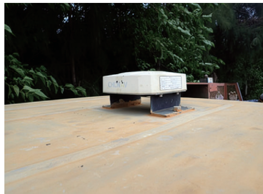
写真1 自動操舵システムのディスプレイ（左）とトラクタに取り付けられたレシーバー（受信機）（右）
