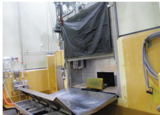
写真1 とさつペンから落下した牛体を受けるトレイ（左端）と、牛体をトレイに押し出す機械（右端）
