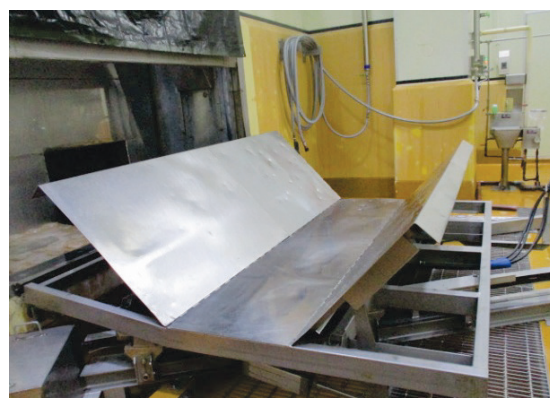
写真2 押し出された牛体を受ける可動式トレイ
