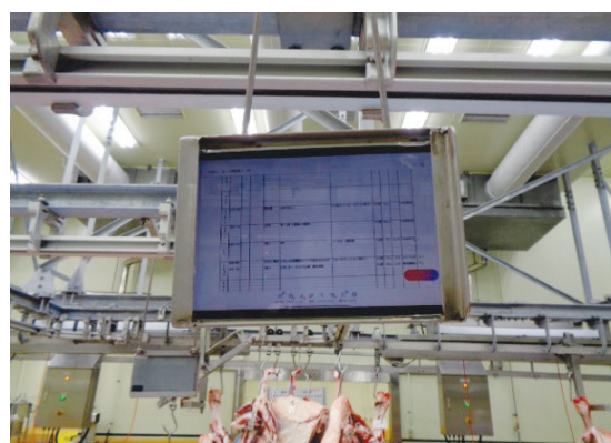
写真3 加工ライン。上部に加工指示が表示されるタブレットがある。
