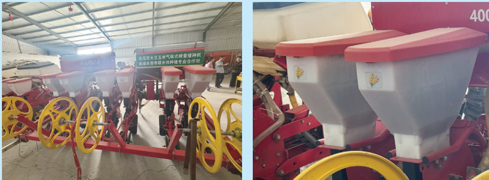
コラム1—写真2（左）4：2モデルの大型作付け機、 （右）ホッパー（容器）にはトウモロコシと大豆のシールが貼られている。
