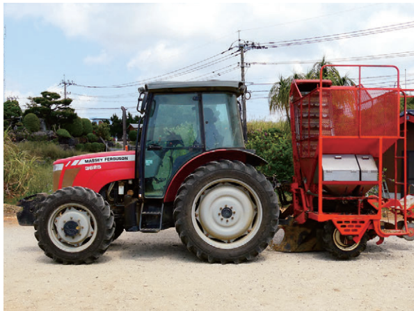
写真3 GNSSトラクター及びピレットプランター（左）、自動操舵画面 五つあるトラクターに乗せ換え可能なGNSSアンテナ（受信機）、モニター（タブレット）、電動ハンドルなどを装着し、作業している。
