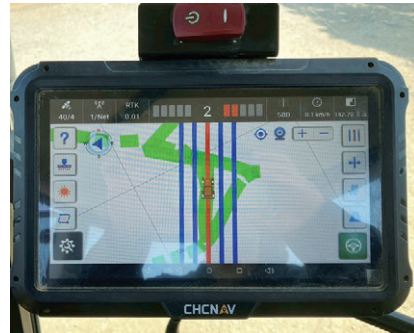
写真3 GNSSトラクター及びピレットプランター（左）、自動操舵画面 五つあるトラクターに乗せ換え可能なGNSSアンテナ（受信機）、モニター（タブレット）、電動ハンドルなどを装着し、作業している。
