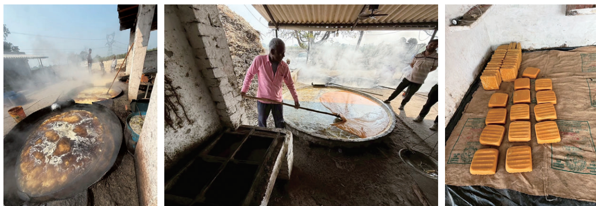
コラム写真－1 ジャグリーの製造 （左：搾汁液加熱工程、中：攪拌冷却工程、右：成形されたもの）
