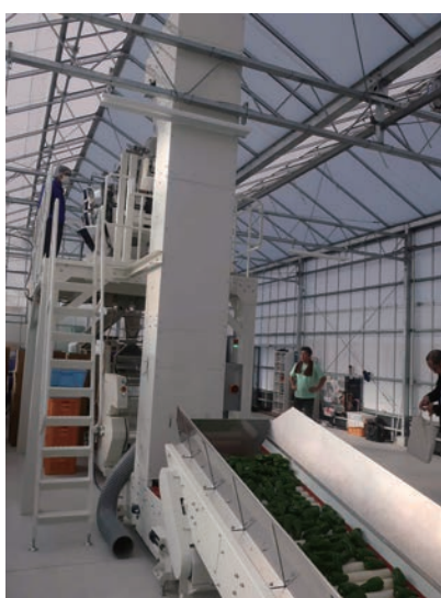
写真3 補助金を活用して導入したピーマンの選果・包装機（筆者撮影）
