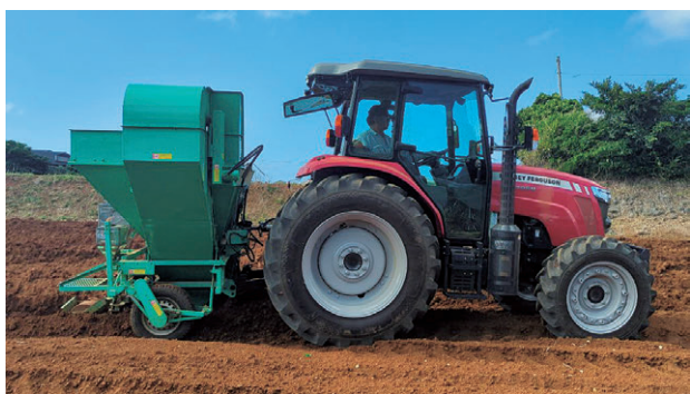
写真6 ピレットプランタによる植え付け作業
